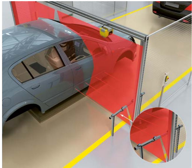
Paso de material con escáneres láser de seguridad, campos de protección verticales y conmutación de los campos de protección con sensores dispuestos de forma adecuada
