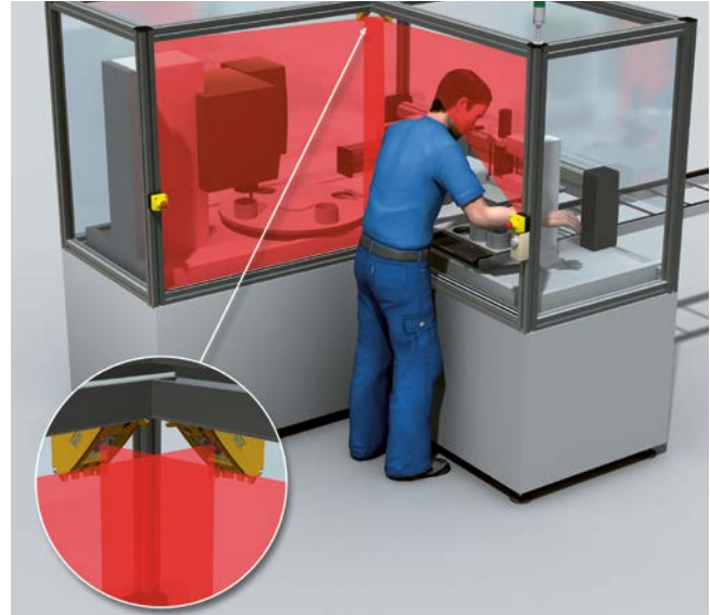
En esta disposición no es posible permanecer dentro de la zona de peligro sin activar el dispositivo de protección. Por eso, no es necesario restablecer por separado el dispositivo de protección (restablecimiento).
