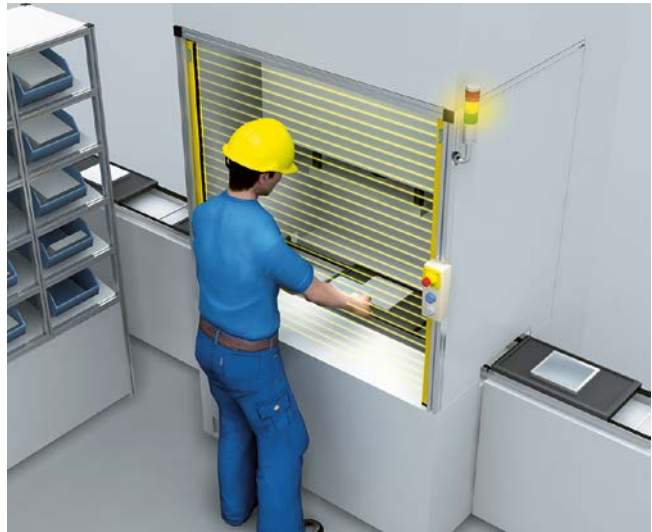
Funcionamiento de 1 ciclo en un sistema de montaje con cortina fotoeléctrica de seguridad. Durante la carga, la herramienta se encuentra en el punto superior. Una vez que el operador haya liberado el campo de protección, se inicia el proceso de montaje.
