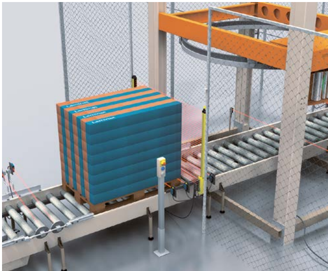
Función de muting con cortina fotoeléctrica de seguridad y sensores de muting en una máquina bobinadora de láminas
