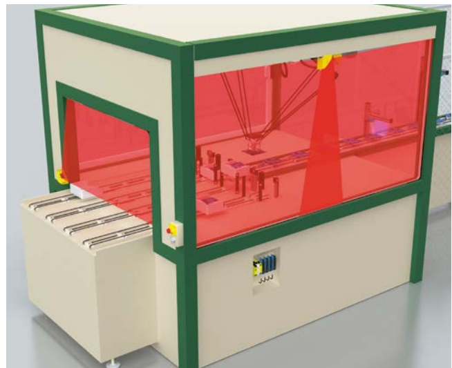
Dispositivo de protección con cámara
