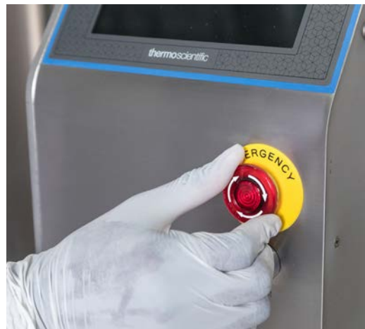
Figur 3–6. Vrid vredet på E-stoppet medurs för att inaktivera.
