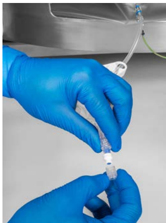
Figur 6-9. Ta bort locket.
