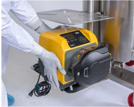
Figur 3–2. Inställning pumpar på hyllor.
