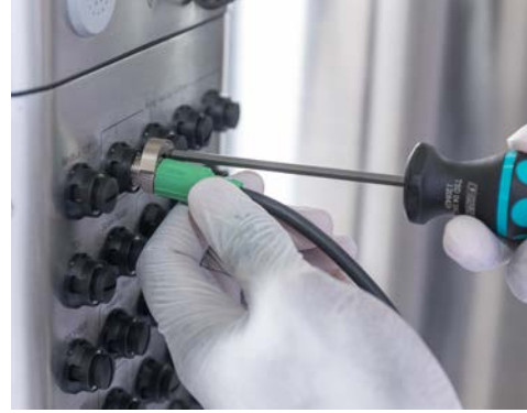
Figur 3–3. Ansluta pumpar till pekskärmkonsolen.
