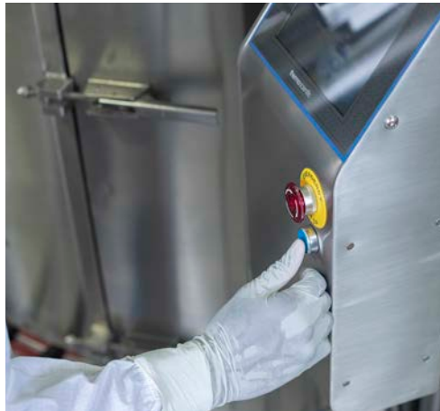
Figur 3-10. Tryck på den blå återställningsknappen för start.
