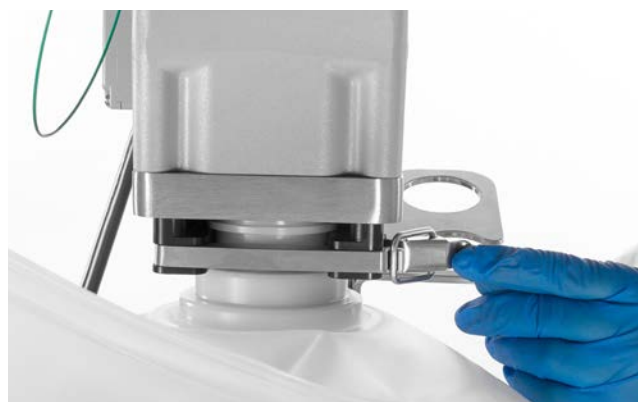
Figur 5-7. Stänga och spärra lagernavmottagaren.
