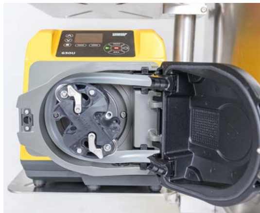
Figur 5-11. Avloppsledning i peristaltisk pump.
