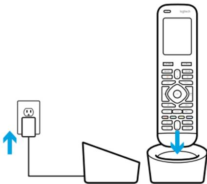
Branchez la base de charge et placez-y la télécommande. Elle doit y rester pendant toute la configuration. La base de charge doit se trouver dans la même pièce que votre hub pour optimiser la communication avec la télécommande.
