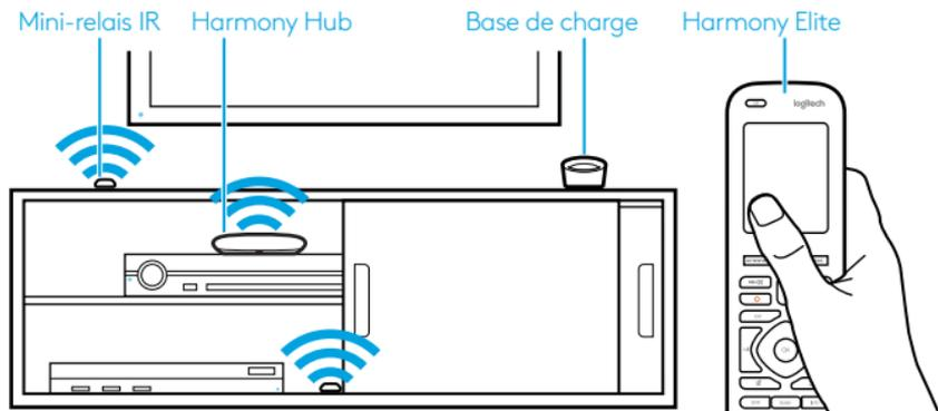
Le hub Harmony peut être placé dans tout endroit non encombré où les signaux IR peuvent être transmis à l'équipement AV ou dans des meubles fermés si les transmetteurs du mini-relais IR sont connectés au hub et positionnés comme illustré ci-dessus.
