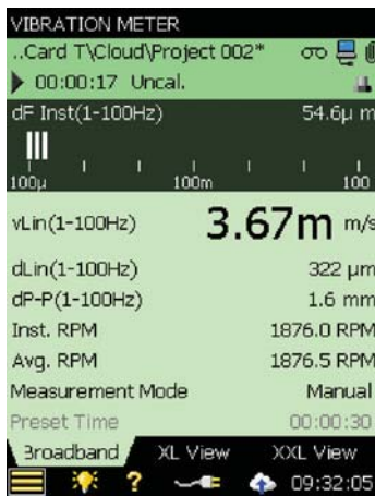
Fig. 2 La vibración mejor permite la medición de la velocidad y el desplazamiento
