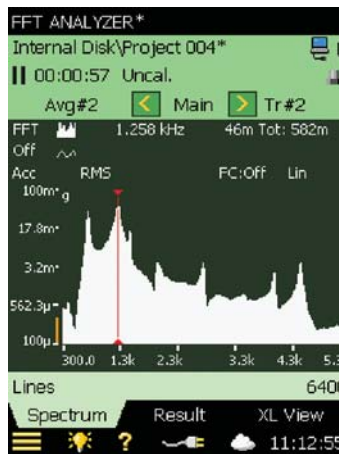
Fig. 3 Vista del espectro en la que se muestran el rango dinámico alto y una resolución de frecuencia alta
