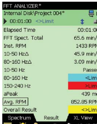
Fig. 4 La plantilla avanzada del analizador de FFT proporciona dos pestañas adicionales con información detallada acerca de los resultados de la prueba
