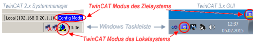
Abb. 102: Unterscheidung Lokalsystem/ Zielsystem (links: TwinCAT 2; rechts: TwinCAT 3)
