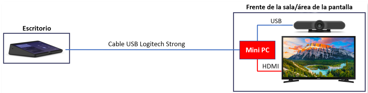
Figura 4: diagrama de instalación de la solución de Logitech para salas pequeñas, incluidos Logitech Tap y MeetUp
