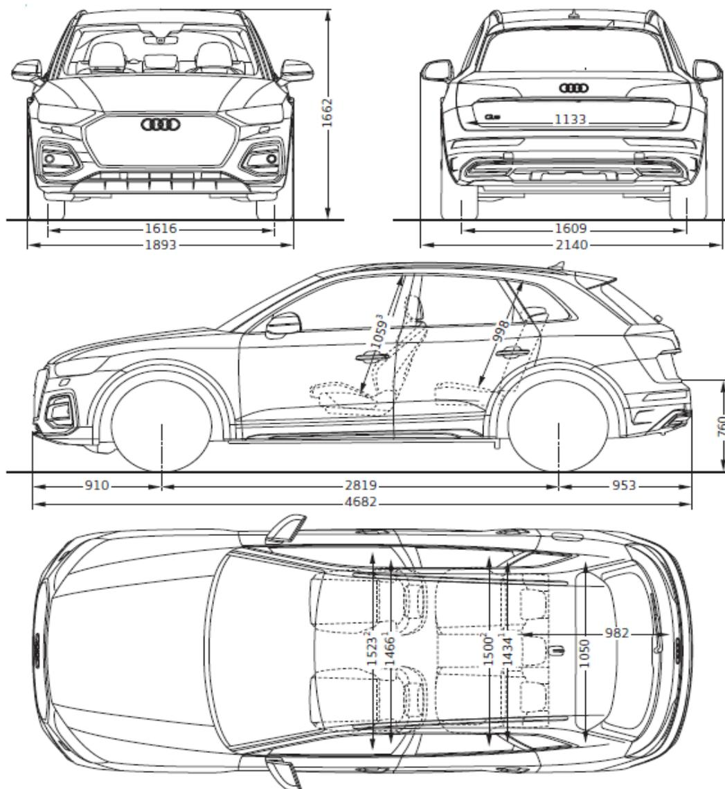
**Misure in millimetri.**
