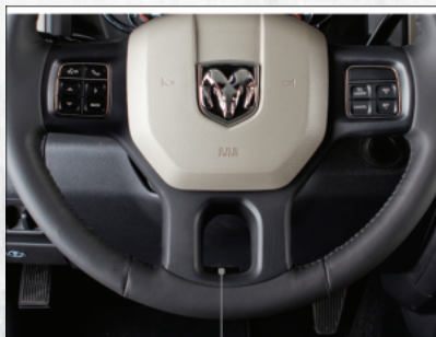
Commande d'ouverture du capot (sous le volant, à la base du tableau de bord)
