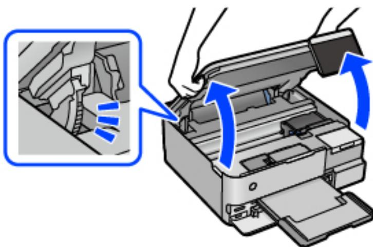
4. Verifique se a película transparente está manchada. As manchas são fáceis de detetar se utilizar uma luz. Se existirem manchas (tais como dedadas ou gordura) na película transparente (A), avance para o passo seguinte.
