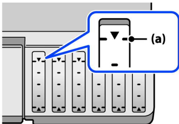
7. Alinhe a parte superior do frasco de tinta com a porta superior, e a seguir coloque-a na porta para encher com tinta até parar automaticamente na linha superior.
