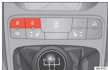
Fig. 111 Central lock button.
