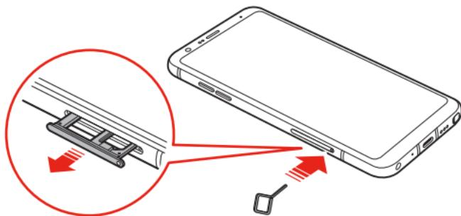
2. Coloque la tarjeta SIM o la tarjeta de memoria en la bandeja para tarjetas y luego, inserte la bandeja para tarjetas en el dispositivo en la dirección que indica la flecha.
