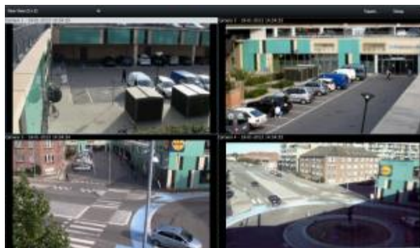
Ejemplo: Sony - Network Video Management System Smart Client mostrando una vista con vídeo desde cuatro cámaras diferentes (una vista de 2x2)
