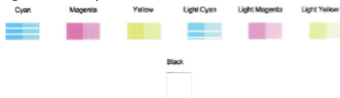
Figura 9-2 Exemplo de blocos de cor sem defeitos
