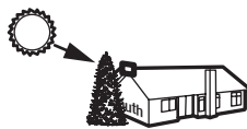
Mala posición: los árboles bloquean la entrada de luz solar al panel solar
