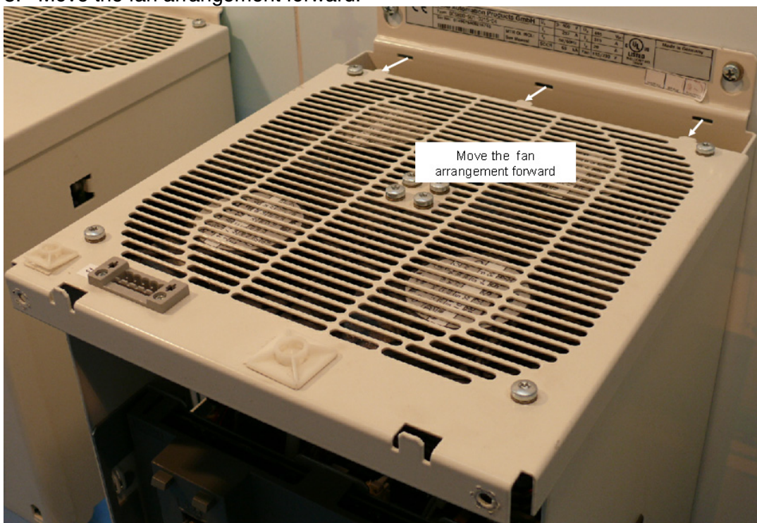
Move fan arrangement
