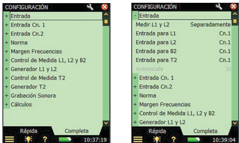
Fig. 4.25 Configuración de entrada doble canal para la medida en acústica de edificios utilizando el modelo 2270
