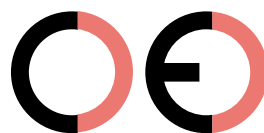
Marcatura CE contraffatta (troppo distante)
