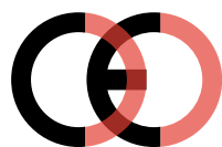
Marcatura CE contraffatta (troppo vicino)
