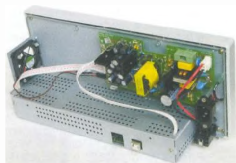
Obr. 24a. Doplnění ventilátoru do Hantek DSO5062B
