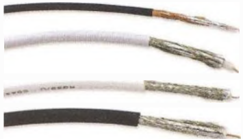
Obr. 7. Řídké opletení levnějších kabelů bývá doplněno hliníkovou fólií
