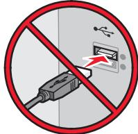
No conecte el cable USB hasta que se le indique en la pantalla
