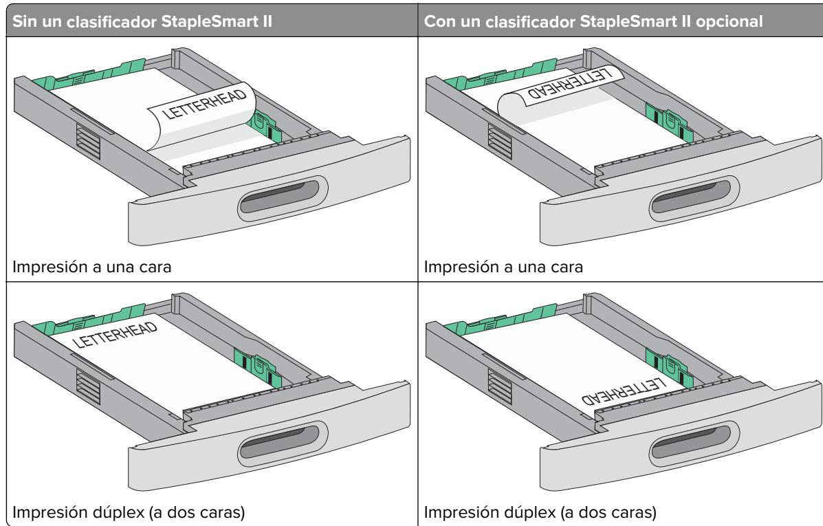
**Nota:** Observe la línea de carga máxima en el lado de la bandeja que indica la altura máxima de carga del papel. No sobrecargue la bandeja.
