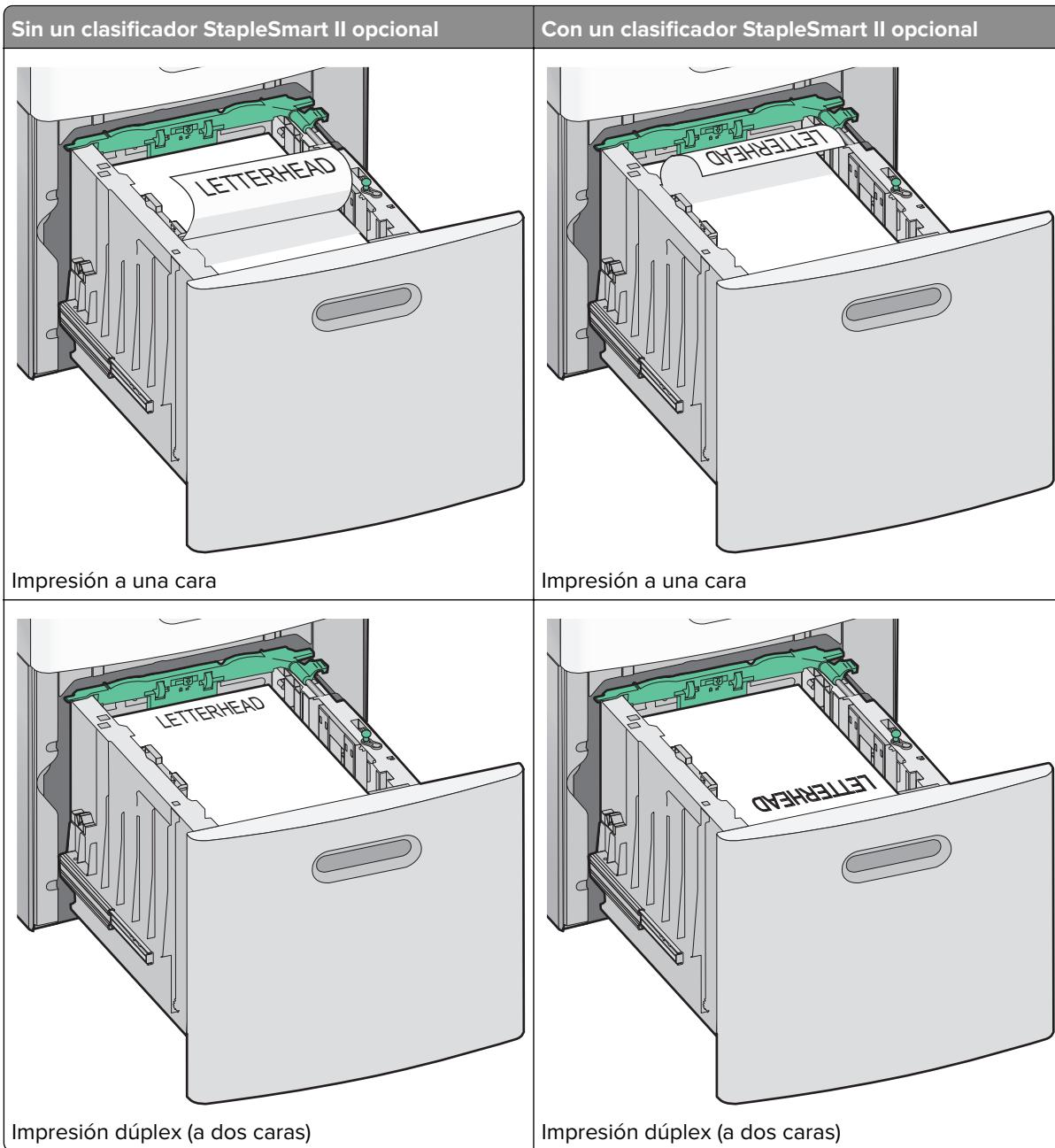
**Nota:** Observe la línea de carga máxima en el lado de la bandeja que indica la altura máxima de carga del papel. No sobrecargue la bandeja.
