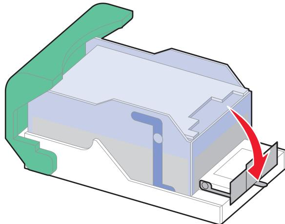
**5** Empuje con firmeza el soporte del cartucho para introducirlo en la unidad grapadora hasta que *encaje* en su lugar.
