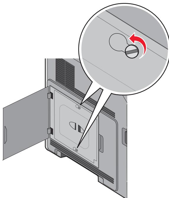
**3** Extraiga la cubierta de la placa del sistema
