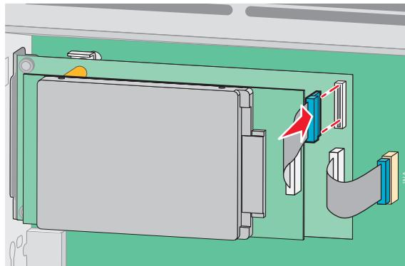
Para instalar un disco duro de impresora directamente en la placa del sistema:
