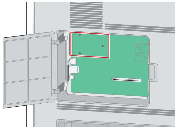
**Nota:** Si hay un disco duro de impresora opcional instalado, primero será necesario desinstalarlo. Para desinstalar el disco duro:
