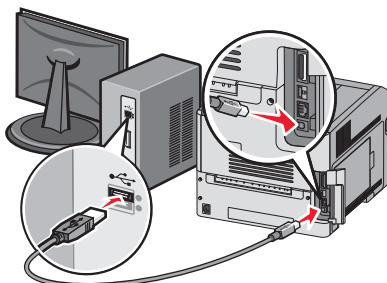
**Nota:** Una vez configurada la impresora, el software le indicará que desconecte el cable USB temporal para que pueda imprimir inalámbricamente.
