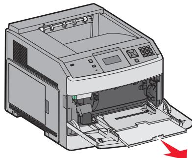
**3** Ajuste y deslice la guía de anchura hasta el lado derecho.
