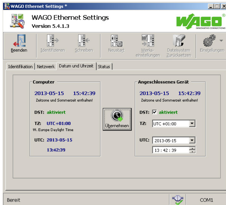
Abbildung 74: ETHERNET-Settings-Beispiel für die Zeitsynchronisation
