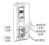
(4) 在用手將錐形螺母擰緊後,使用扭矩扳手做完全擰緊的動作。
