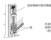
將連接電纜和電源電纜拉到室外機組後面的 2 個閥門之間,如圖如示。
