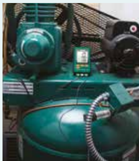
SD750 Registrador de Informações/Medidor de Pressão de 3 Canais (pág. 99)
