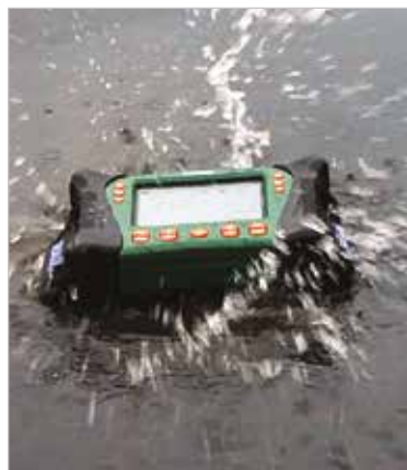
O invólucro à prova de queda e d'água atende aos padrões IP67.
