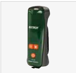
HDV-WTX Transmissor Sem Fio mede até 100 pés (30 m) distante do alvo
