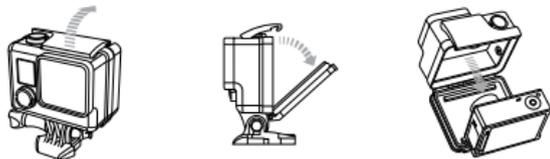
2. 卸下相機側邊護蓋，並插入 microSD 記憶卡（另售）。記憶卡必須至少為 Class 10 或 UHS-I 等級，且容量最高可達 64GB。請造訪 [gopro.com/support](http://gopro.com/support)，以取得通過 GoPro 測試的 microSD 記憶卡清單。
