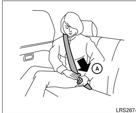
2. Jale lentamente el cinturón de seguridad para sacarlo del retractor e inserte la lengüeta en la hebilla (A) hasta que escuche y sienta que el pestillo se acopla.
