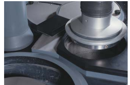
4. Während die nächsten Probenhalter zur Aufnahme bereitstehen, wird das Schleifen ausgeführt
