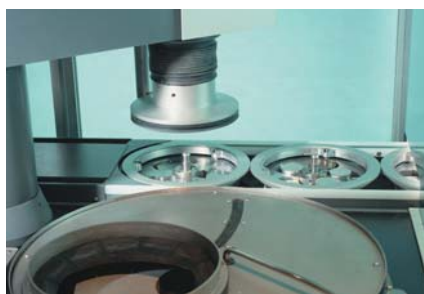
2. La bande de transport fait avancer les porte-échantillons en première position - le prépolissage plan
