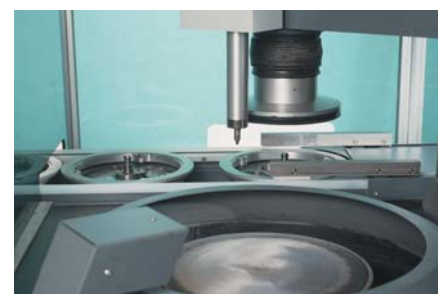
7. Nach Abschluss der Präparation wird der Probenhalter wieder auf dem Transportband abgesetzt, wo er zur weiteren, z.B. mikroskopischen, Untersuchung bereitsteht
