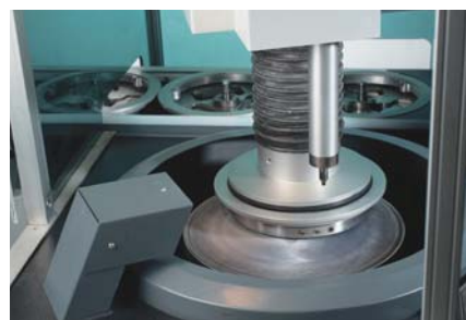
6. Après le prépolissage fin, le porte-échantillons se dirige vers la station de polissage
