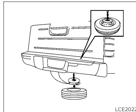
7. Para reinstalar la rueda, inserte la cadena para llantas a través de la rueda. Asegúrese de que el espaciador de hule esté centrado en la rueda antes de levantarla. Utilice la barra del gato ensamblada y lentamente gire el cabestrante hacia la derecha para levantar la rueda al vehículo.
