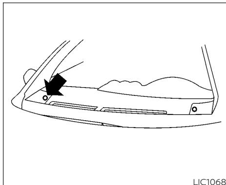
**Asegúrese de no poner nada encima del sensor de las luces automáticas situado en la parte superior del tablero de instrumentos. El sensor de autoiluminación controla la autoiluminación; si lo cubre, el sensor de autoiluminación reaccionará como si hubiera oscurecido afuera y los faros se encenderán. Si esto ocurre con el vehículo estacionado, el motor apagado y el interruptor de encendido en la posición ON (Encendido), el acumulador de su vehículo podría descargarse.**
