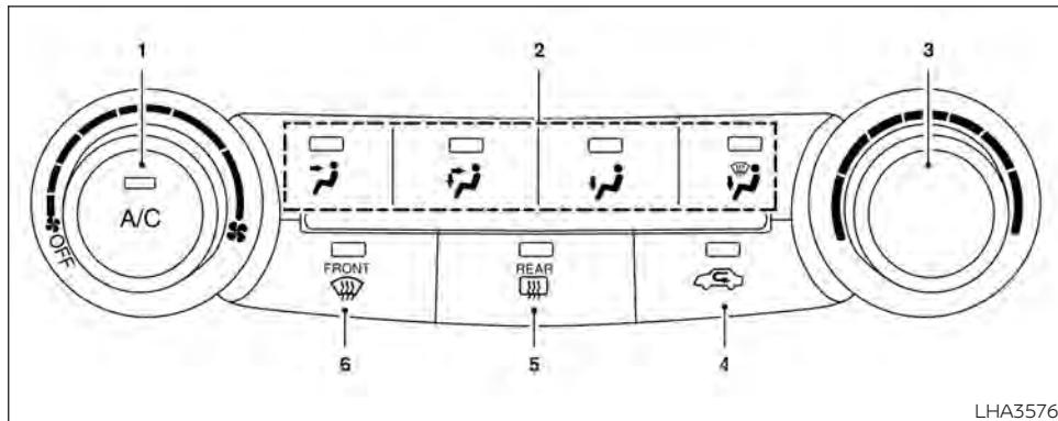
1. Botón del control de velocidad del ventilador/del sistema de aire acondicionado (A/C)
