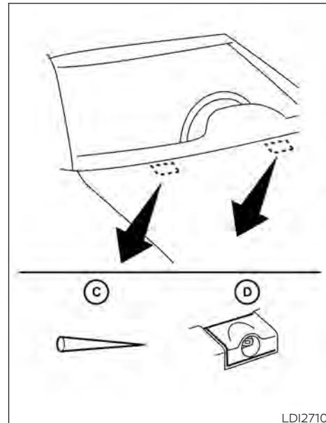
Tenga cuidado de no permitir el ingreso de ningún elemento a la boquilla del lavador **D**. Esto puede provocar obstrucciones o un funcionamiento incorrecto del lavaparabrisas. Si ingresa algo en la boquilla, quitelo con una aguja o con un alfiler pequeño **C**.
