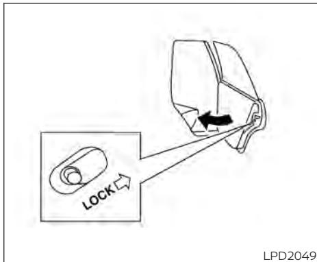
**Cuando la palanca está en la posición LOCK (Bloqueo), la puerta sólo se puede abrir desde afuera.**
