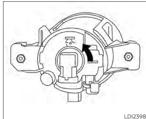
Reemplazo del foco del faro antiniebla (sólo si está equipado)
