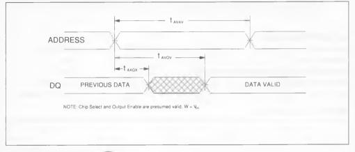
Figure 3b : Read Timing N°2 ( $\overline{W} = V_{IH}$ ).
