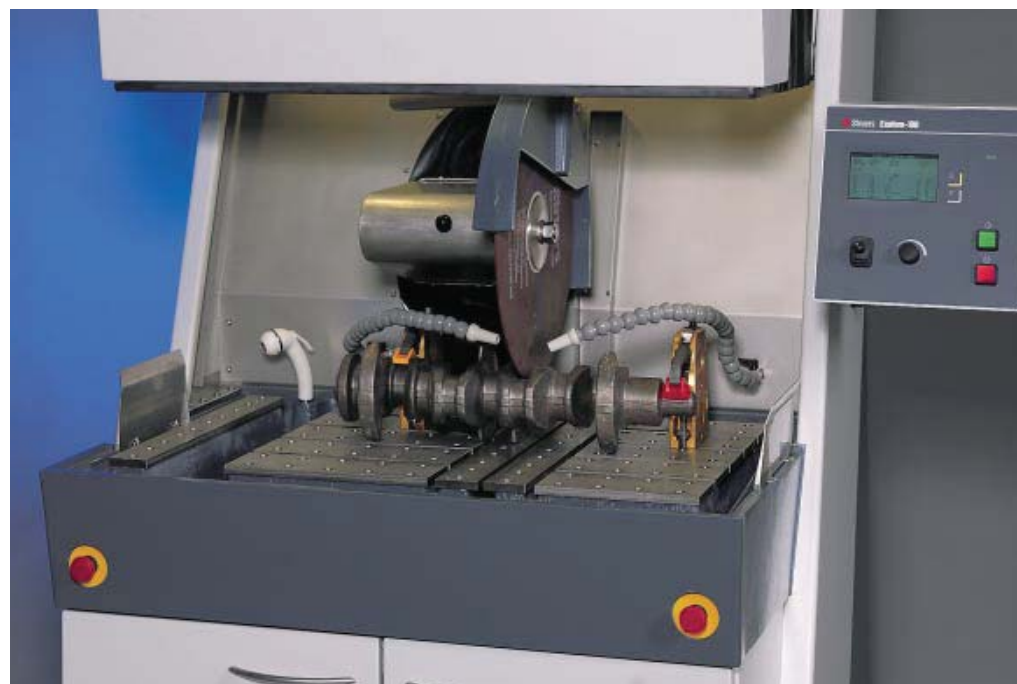
Compartiment de tronçonnage exceptionnellement spacieux et accessible: même les pièces les plus grandes sont facilement placées sur la table de tronçonnage
