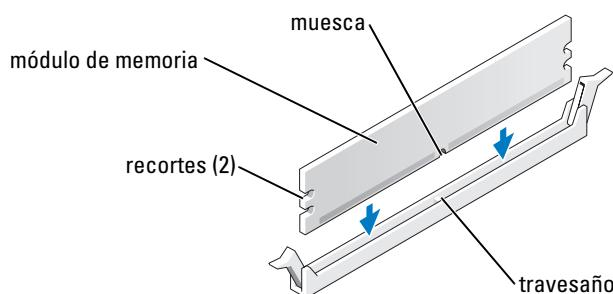
► **AVISO:** para evitar que se dañe el módulo de memoria, presiónelo hacia abajo en línea recta insertándolo en el conector, aplicando la misma fuerza en cada extremo del módulo.
