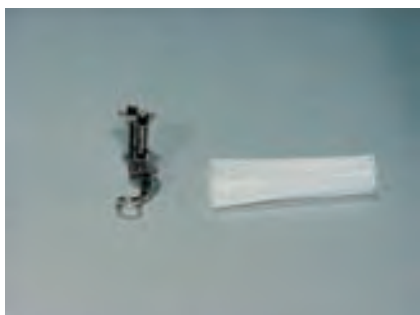
Stickfuss Nr. 15 Netz für gleichmässigen Fadenablauf (über Oberfadenspule stülpen)
