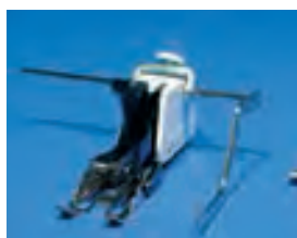
50 Obertransportfuss Nähen von schlecht gleitenden Materialien sowie Stoffen, die zum Verschieben neigen; Quiltarbeiten
