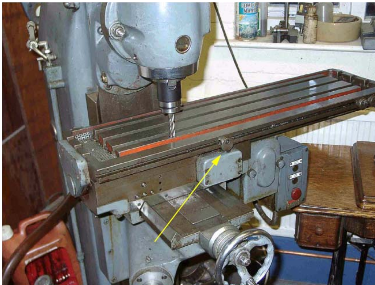
Figura 4-10: Ferramenta em X=0 , Y=0 , Z=0 (note o cão está no limite do interruptor)
