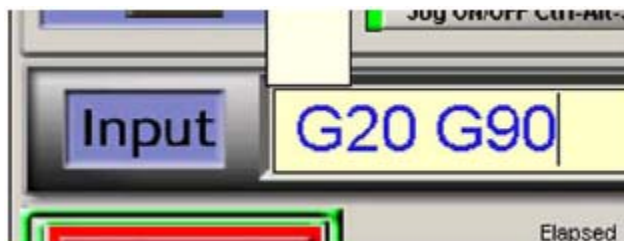
Figura 5-17: Entrando com Comandos Manualmente de G20 G90
