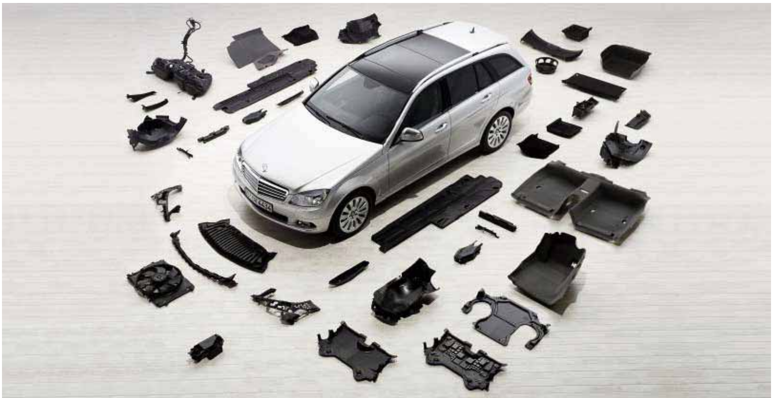
Mercedes-Benz C-Klasse T-Modell mit Umweltzertifikat: 39 Bauteile wurden für Rezyklat-Kunststoffe freigegeben, 32 Bauteile bestehen aus nachwachsenden Rohstoffen.
