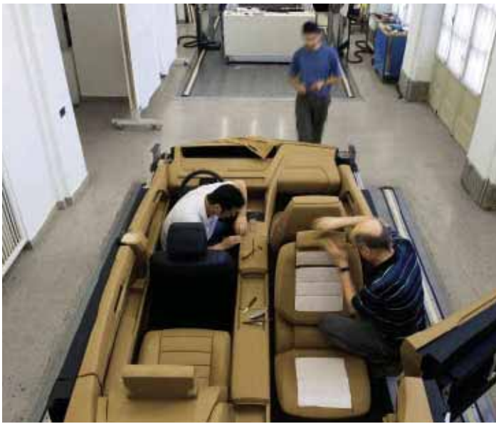
An einem 1:1-Tonmodell veranschaulichen die Designer, wie der Innenraum des F 700 mit REVERSE-Sitz aussehen wird.
