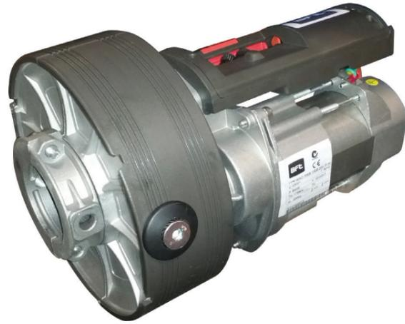
Opérateurs 230 V pour rideaux métalliques fournissant un couple maximum jusqu'à 445 Nm. Adaptés à équipés les rideaux avec poulie de 200, 220, 240 et 280 mm de diamètre et arbre de 42, 48, 60, 76 et 101 mm de diamètre. Existent en versions avec ou sans électrofrein.
