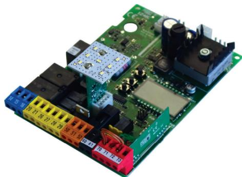
Armoire de commande pour 1 ou 2 opérateurs pour la motorisation de portes de garage basculantes.
