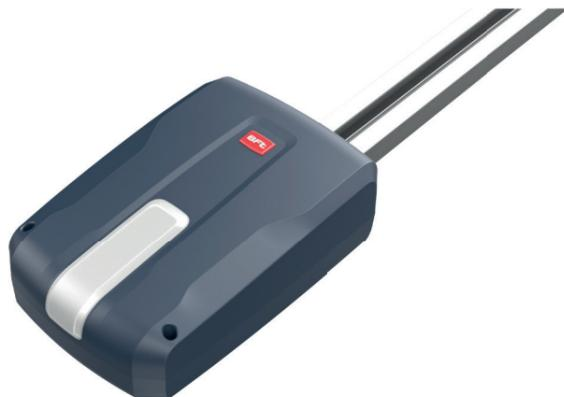
Opérateurs électromécaniques pour usage intensif/très intensif, conçus pour la motorisation de portes de garage sectionnelles. S'adaptent parfaitement à tous types de contextes architecturaux, grâce à un grand choix de rails à chaînes ou à courroie de différentes longueurs. La centrale de commande gère le fin de course par encodeur intégré au moteur. La butée mécanique intégrée au rail sert de sécurité haute.
