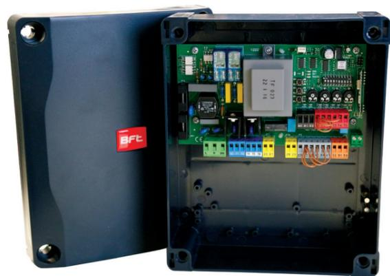
Armoire de commande à interrupteurs de programmation (dip switch) et potentiomètres pour un ou deux opérateurs 230 V pour la motorisation de portails battants et de portes industrielles pliantes
