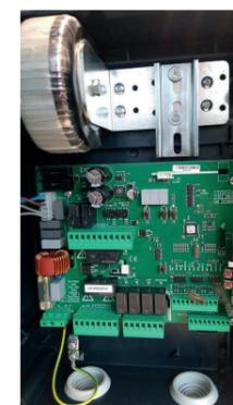
Armoire de commande pour bornes escamotables électromécanique ou hydraulique.
