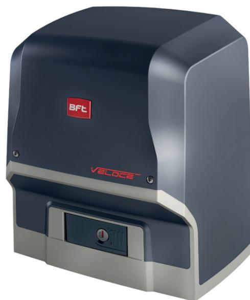
Opérateur rapide 24 V pour portails coulissants à usage intensif jusqu'à 500 kg. Vitesse de manœuvre sans charge de 25 m/min. Contrôle intelligent du couple par le biais de la technologie D-Track. Centrale de commande pré-équipée pour utiliser le protocole de communication U-Link. Opérateur avec fin de course électromagnétique. Solution idéale pour les environnements nécessitant des vitesses de manœuvre élevées, des temps d'attente réduits et des hauts niveaux de sécurité.
