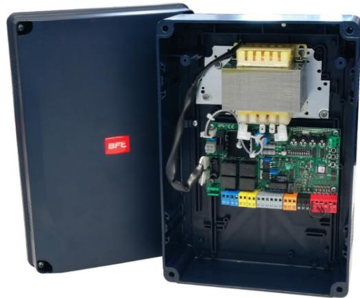
Armoire de commande à interrupteurs de programmation (dip switch) et potentiomètres pour 1 ou 2 opérateurs 24 V pour la motorisation de portails battants
