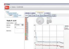
Toutes les fonctions et les paramètres peuvent être affichés et modifiés à l'aide d'un PC. L'interface graphique permet par ailleurs de visualiser les courbes de vitesse et d'absorption en temps réel.
