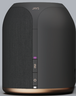
Фиолетовый светодиодный индикатор — режим Wi-Fi
