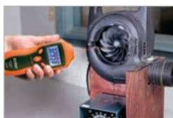
Medição da velocidade (RPM) de objetos giratórios e contagem (revoluções) de objetos em movimento
