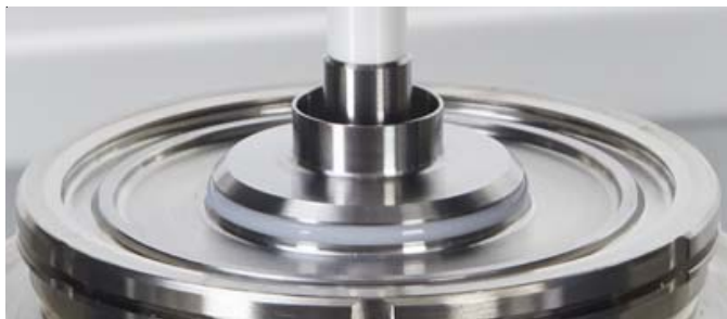
Abbildung 7: Messplattenaufsatz TMP mit einem auf den Rotor abgestimmten Durchmesser.
