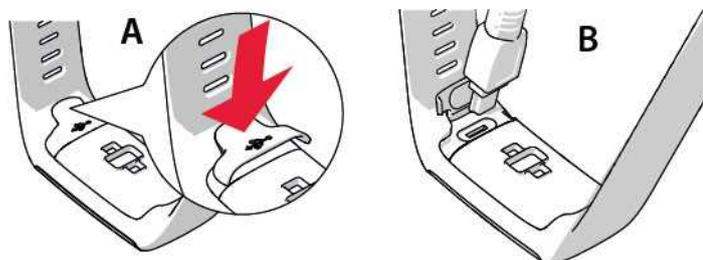
2. 將連接線的另一端插入電腦的 USB 埠。在將 A360 連接至電腦前，請檢查 USB 埠是否乾爽。若電池電量完全耗光，需要等待幾分鐘充電才能開始。
