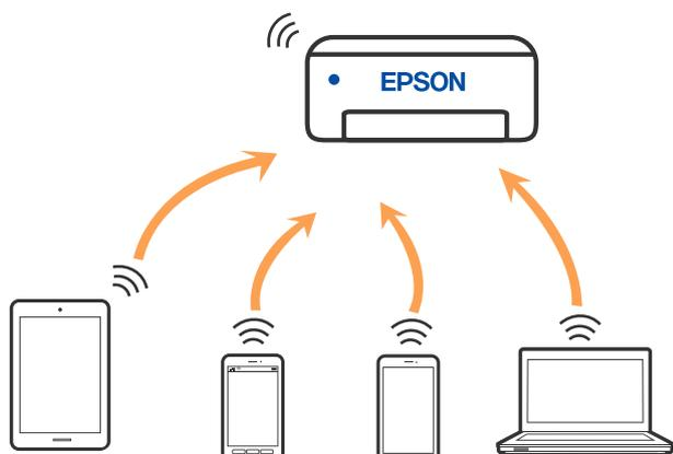
La impresora puede conectarse por Wi-Fi o por Ethernet, y por conexión Wi-Fi Direct (PA simple) simultáneamente. No obstante, si inicia una conexión de red mediante Wi-Fi Direct (PA simple) cuando la impresora está conectada por Wi-Fi, la red Wi-Fi se desconectará temporalmente.
