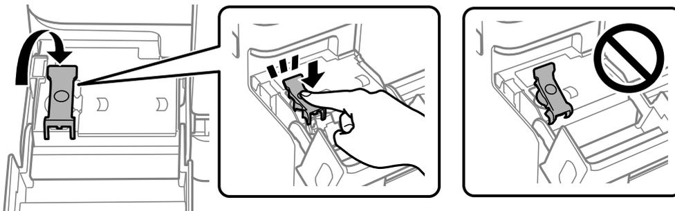
11. Cierre bien la cubierta del tanque de tinta.
