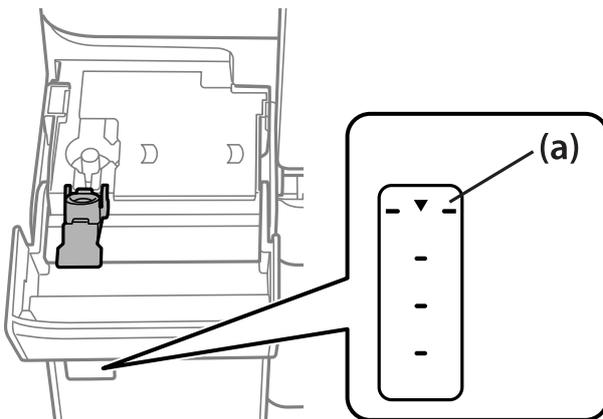
8. Alinee la parte superior del bote de tinta con el puerto de llenado y, a continuación, introdúzcalo recto en el puerto de llenado la tinta hasta que se detenga automáticamente en la línea superior.
