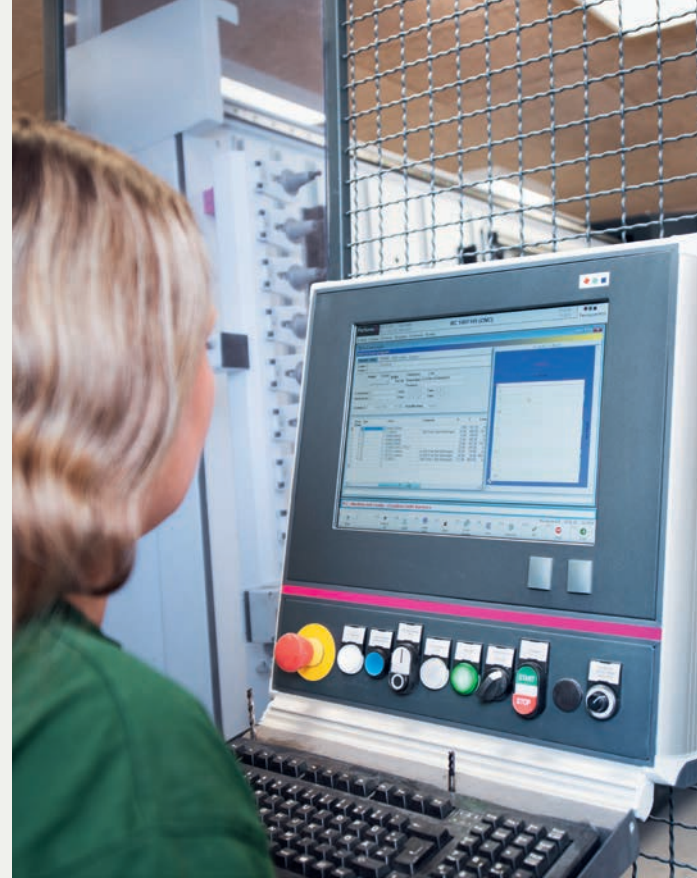
Fra projektafdelingen sendes tavlens data og virtuelle tegning til bearbejdningsanlægget, som fræser alle huller i stål-kabinettet i en fuld-automatisk proces.
