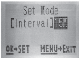
[Paso 7]: ajustar el intervalo de exploración de campo
