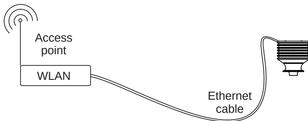
Figura 2.3 Conexión de refratômetro(s) de forma inalámbrica.
