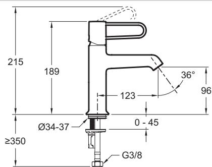
Descriptif CCTP : Mitigeur lavabo personnalisable, sans vidage. E21029-CP. Collection : ODÉON RIVE GAUCHE. POIDS : 1 kg. TYPE D'INSTALLATION : 1 trou. TYPE : Mitigeur. DÉBIT (L/MN SOUS 3 BARS) : 5 l/mn. HAUTEUR TOTALE DU ROBINET (MM) : 189. SAILLIE DU BEC (MM) : 123. RACCORDS : Avec flexibles d'alimentation. MÉCANISME : Cartouche à disques céramique. VIDAGE : Sans vidage. TYPE D'INSTALLATION : 1 trou. GARANTIE MÉCANISME : 5 ans. GARANTIE FINITION : Chrome 10ans / Blanc et Noir Mat 5ans.
