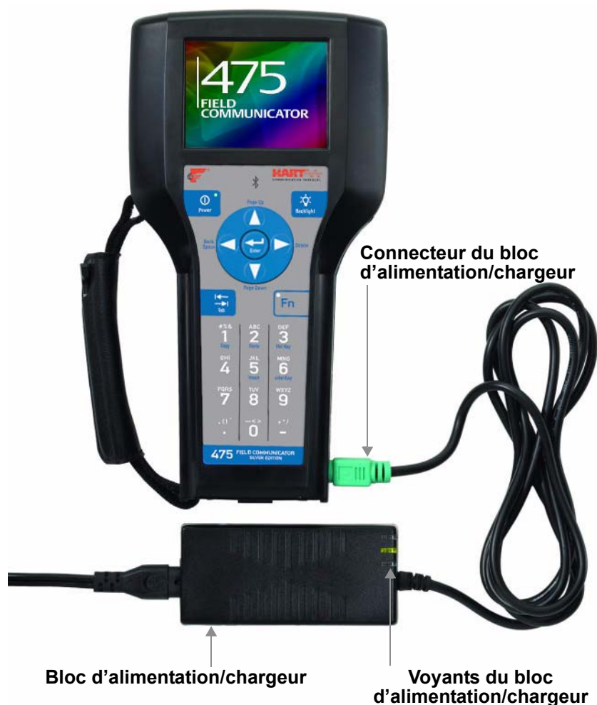
Figure 2-2. Charge de la batterie connectée à l'interface de communication 475
