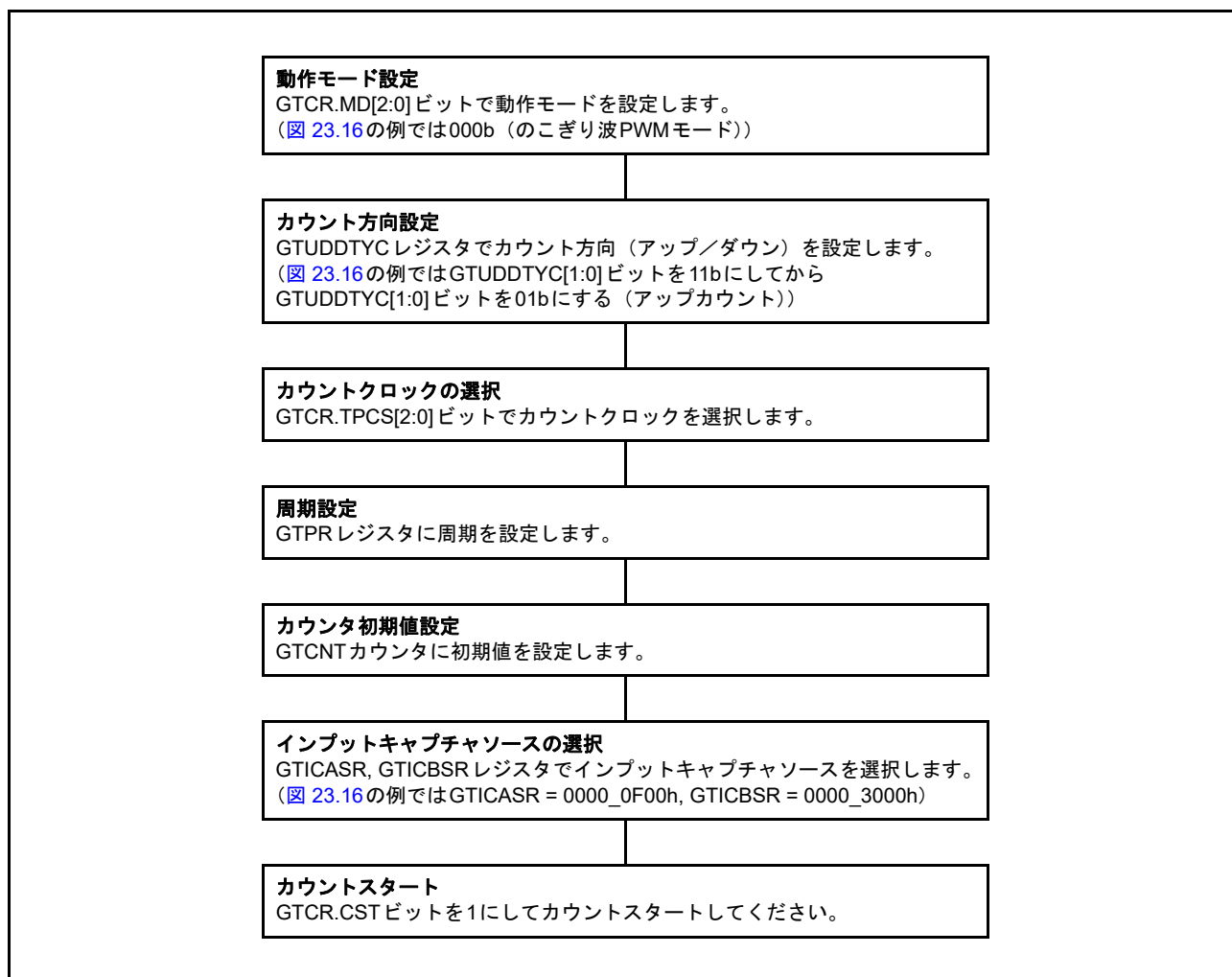
図 23.17 インプットキャプチャ動作設定例
