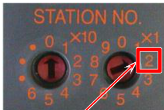
Estación n.º 2: estación E/S remota (AJ65BTC1-32T, salida de transistor de 32 puntos)
