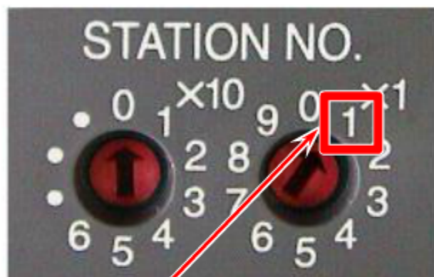
Estación n.º 1: estación E/S remota (AJ65BTB2-16D, entrada CC de 16 puntos)
