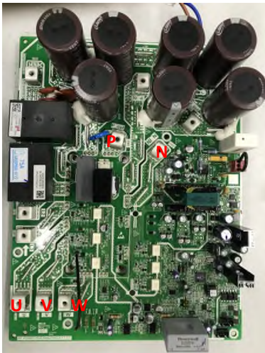
Figura 85: Terminais do módulo inverter (220 V)
