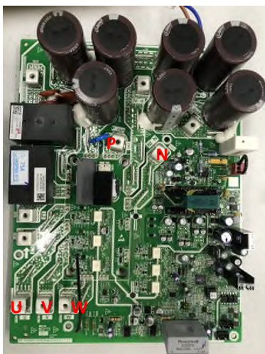
Figura 87: Terminais do módulo inverter (220 V)
