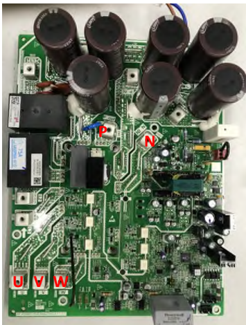
Figura 74: Terminais do módulo inverter (220 V)
