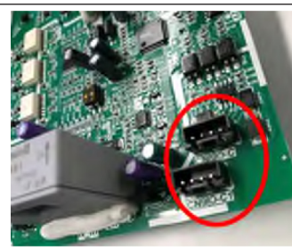
Figura 80: LED1/2 no módulo inverter (380 V)
