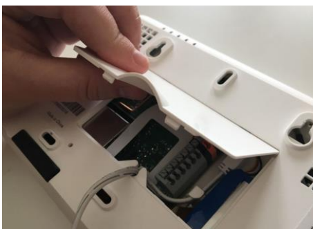
Placer le haut du couvercle sur la plaque arrière du panneau
