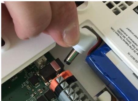
Brancher le connecteur d'alimentation
