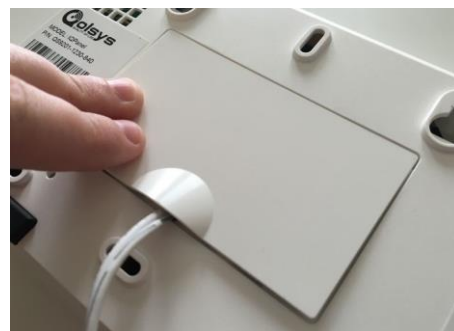
Replacer le couvercle et appuyer jusqu'à ce qu'il s'enclenche.
