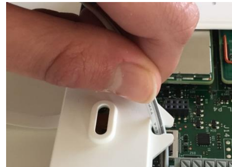
Insérer le câble dans le serre-câble
