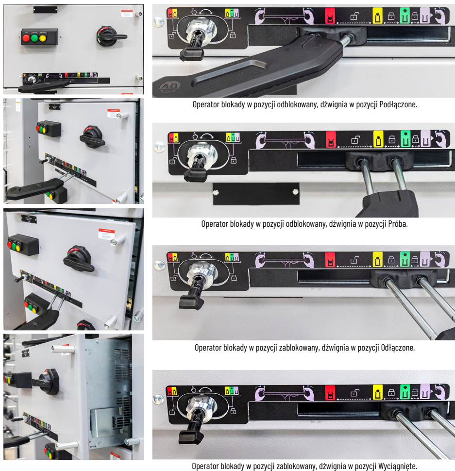
Rys. 36 - Różne pozycje członów wysuwnych z SecureConnect
