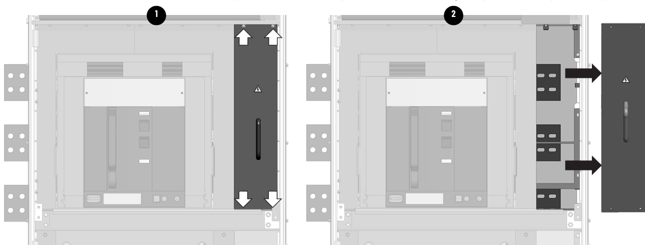
Rys. 15 - Usuwanie pokryw łączenia na członie głównym (rama 4) z jedną pokrywą.
