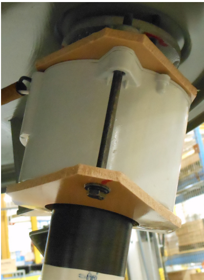
Figure 18. Transformateur de courant interne monté sur traversée
