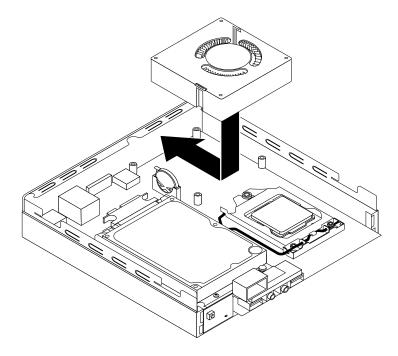
Figure 223. Installing the system fan
